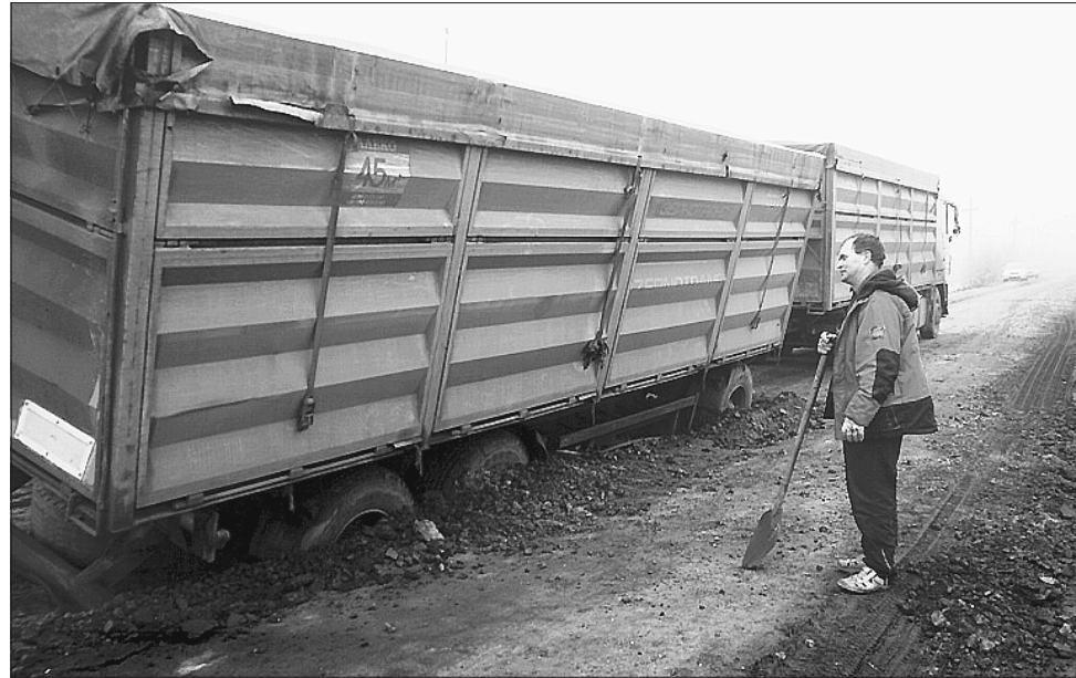
Шляхове покриття не витримало непомірного навантаження
