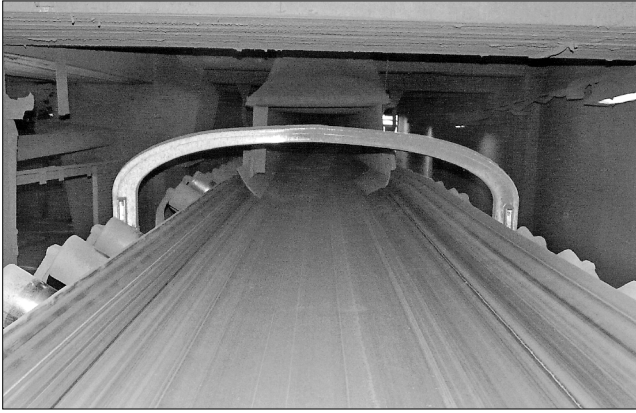
Скромна рамка стане надійним бар'єром для предметів, що можуть пошкодити обладнання
