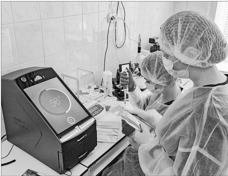
За 90 хвилин цей апарат визначає ДНК-профіль і заносить його в базу даних
