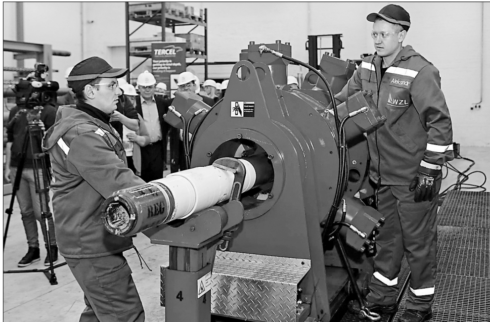
Під час демонстрації нового сервісного цеху увагу учасників привернула брекаут-машина, або гідравлічний ключ, що слугує для проведення тестувань двигунів та іншого обладнання, що використовується при бурінні свердловин
