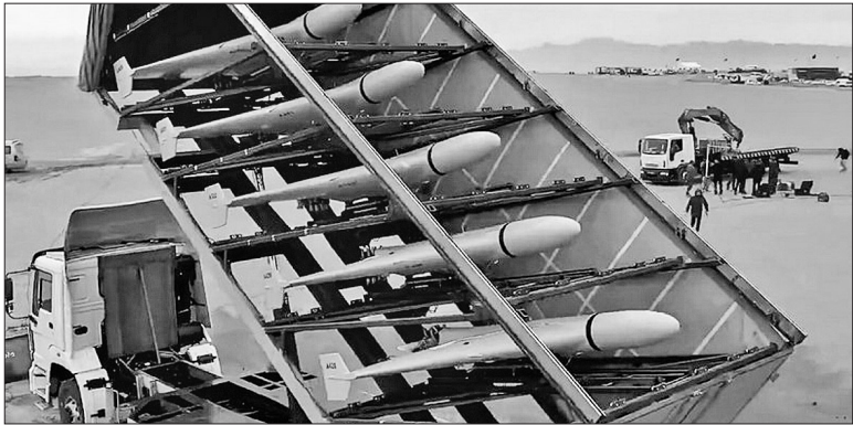
Установка для запуску дронів виконана у вигляді контейнера, замаскована під вантажівку, вагони поїздів
