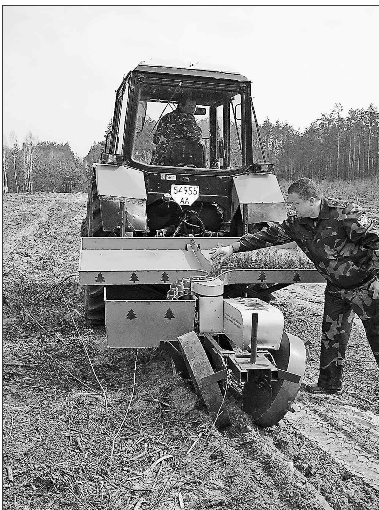
Створений на Житомирщині унікальний агрегат механізував посадку саджанців із закритою кореневою системою
