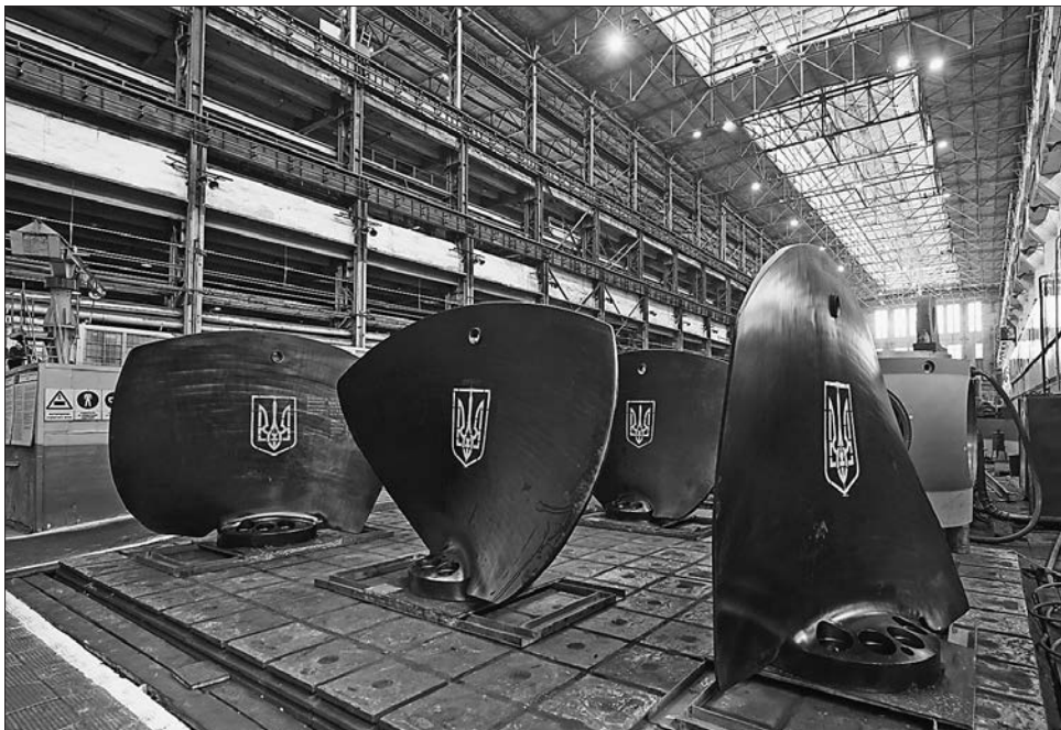
Лопаті робочого колеса гідротурбіни
