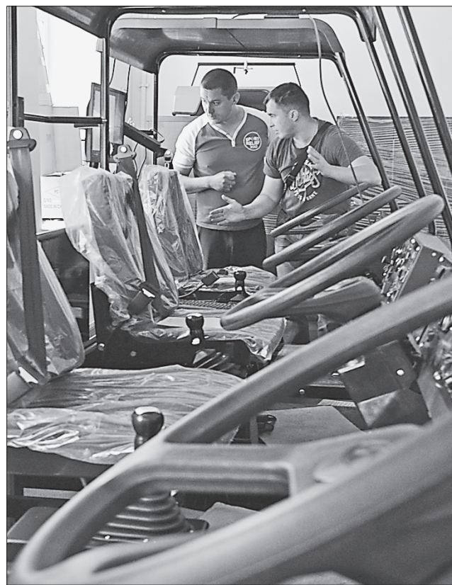
Імітатор кабіни вантажного чи легкового автомобіля має основні реальні вузли керування і забезпечує порядок роботи справжнього автомобіля
