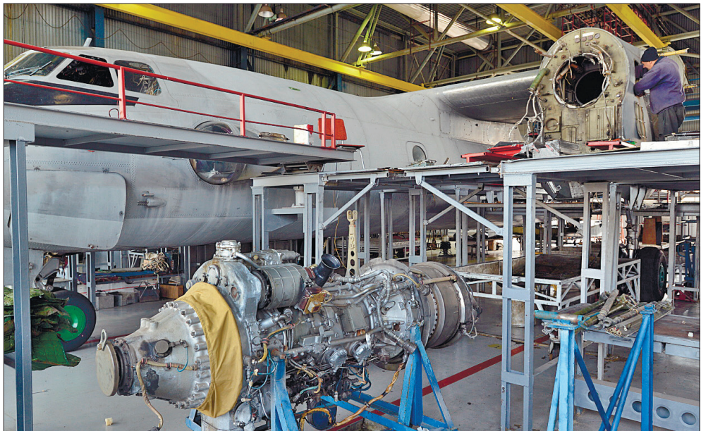
Літаки серії Ан в одному з найбільших цехів заводу розбирають до останньої заклепки. Для кожного повітряного судна цей процес індивідуальний та особливий
