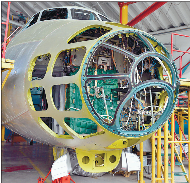
Літаки серії Ан в одному з найбільших цехів заводу розбирають до останньої заклепки. Для кожного повітряного судна цей процес індивідуальний та особливий
