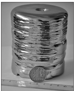
Супервеликий монокристал вольфраму у вигляді циліндра
