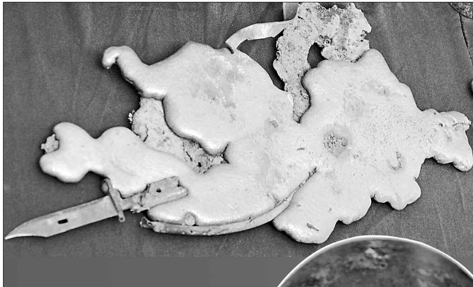
Так розплавився алюміній із двигуна БТРа
